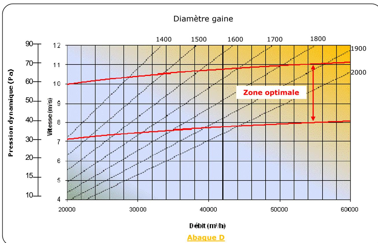
Exemple de dimensionnement de gaines textiles poreuses TEXI-SOFT :
