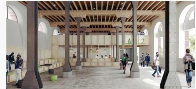
**5 RÉHABILITATION DE LA MANUFACTURE DES TABACS ET EXTENSION DU PÔLE G2EI – RÉEMPLOI IN SITU- STRASBOURG –** Dans ce projet de rénovation, le réemploi des éléments structurels existants a nécessité une stratégie de renforcement et de traitement différencié pour assurer leur pérennité. Menuiseries de façade, charpente, planchers en bois et poteaux en fonte d'origine ont ainsi été remis en état et réemployés in situ.
