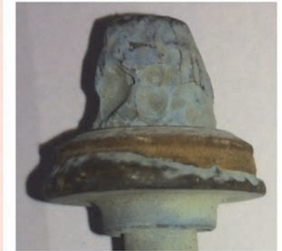
Conditions d'apparition du phénomène de cavitation et photo d'un obturateur de vanne d'équilibrage statique endommagé
