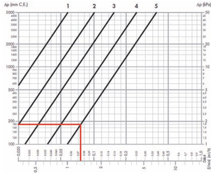
Diagramme débit pression d'un robinet thermostatique à pré-réglage (Caleffi)
