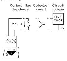
Le contact libre de potentiel a un courant de mouillage nominal de 270  $\mu A$ . L'entrée est sur ON lorsque le contact est fermé.
