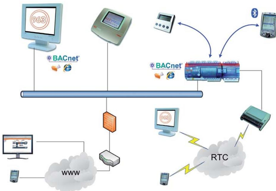
L'utilisation des outils standards des services Web permet au contrôleur IQ3xcite de communiquer simplement au travers des réseaux IP et de pouvoir transmettre les données d'alarmes par Email ou de mettre à disposition des schémas ainsi que des courbes d'historiques aux utilisateurs des navigateurs internet.
