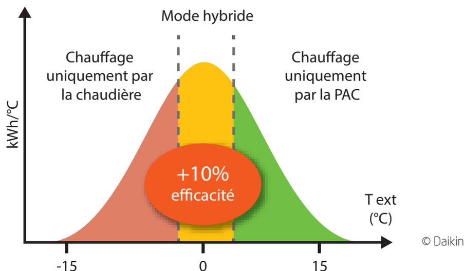
Le 3<sup>e</sup> mode, aussi dénommé, "Daikin Flow control" est une innovation brevetée DAIKIN, qui n'existe sur aucun autre système hybride. Grâce à cette fonction, il est possible, en diminuant le débit, d'augmenter le Delta T, et donc de disposer d'un retour chauffage le plus froid possible permettant de préchauffer l'eau grâce à la pompe à chaleur. L'objectif : optimiser l'utilisation de la pompe à chaleur pour réduire la facture énergétique.
