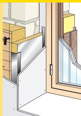
Multimax 30 permet de réduire le pont thermique du tableau de la fenêtre, soit par l'intérieur, dans le cas d'une isolation par l'intérieur, soit par l'extérieur, dans le cas d'une isolation par l'extérieur.
