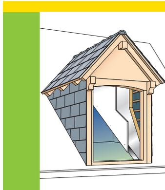
Multimax 30 permet d'isoler entre les montants de la lucarne, tout en ménageant une lame d'air d'au moins 2 cm, sans perte d'espace habitable.
