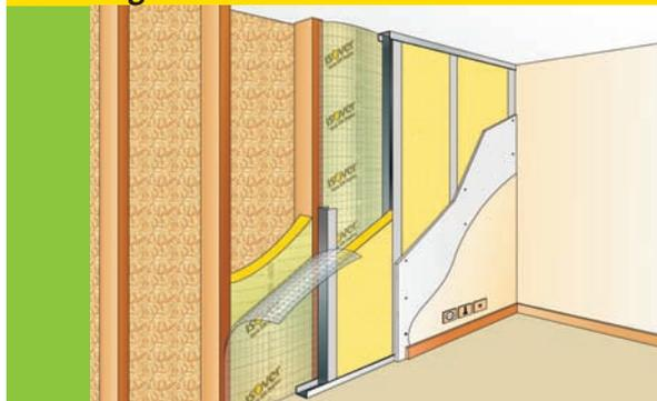
Dans les maisons à ossature bois, il reste souvent un espace vide entre le pare vapeur et la plaque de plâtre. Utilisé entre montants, Multimax 30 apporte un gain significatif en isolation acoustique et thermique sans empiéter sur l'espace habitable.
