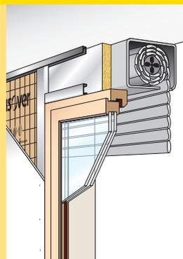
Multimax 30 permet d'isoler efficacement le peu d'espace entre le coffre de volets roulants et la plaque de plâtre, dans la continuité du doublage isolant.
