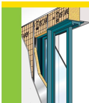
Simple de mise en œuvre entre montants autoportants, Multimax 30 permet d'isoler l'espace disponible entre la baie et le doublage en plaque de plâtre.
