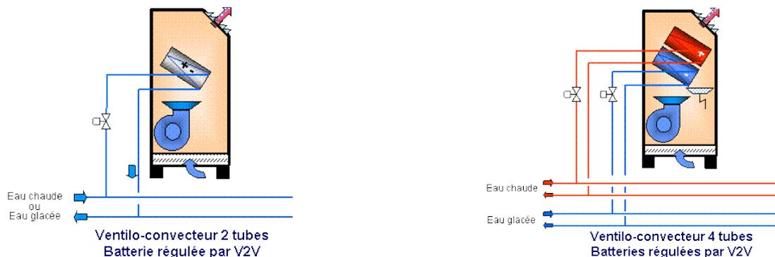
**Question Q2:** Comparez les avantages et inconvénients de la régulation des batteries à eau chaude et froide des ventilo-convecteurs par des vannes 2 voies ou par des vannes 3 voies.
