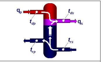
La température de départ secondaire est inférieure à la température de départ primaire  $(t_{ds} < t_{dp})$ . La température de retour primaire est égale à la température de retour secondaire  $(t_{rp} = t_{rs})$ . Si une telle situation a été prévue à la conception, cette bouteille peut être appelée bouteille de mélange.
