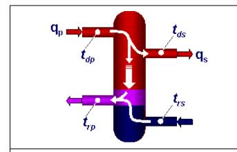
La température de départ secondaire est égale à la température de départ primaire  $(t_{ds} = t_{dp})$ . Une partie du débit primaire descend dans la bouteille et se mélange au retour. La température de retour primaire est supérieure à la température de retour secondaire  $(t_{rp} > t_{rs})$ .
