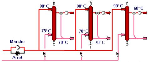
Circuit primaire Sous-station n°1 Sous-station n°2 Sous-station n°3
