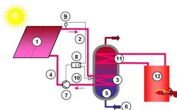
Chauffe-eau solaire à éléments séparés avec chauffage d'appoint (modèle avec circulation forcée)
