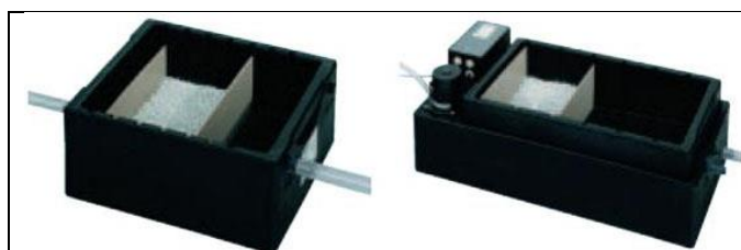
Fig. 34 : Equipement de neutralisation par granules pour débits de condensats des chaudières gaz jusqu'à 70 l/h soit 500 kW de puissance environ
