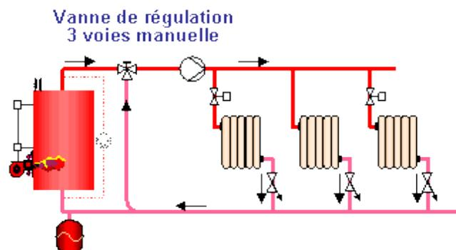
**Question Q2:** Décrivez le principe de régulation de l'installation de chauffage ci-dessous.
