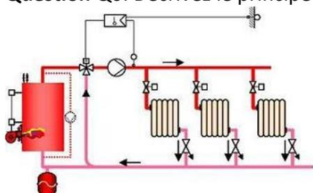
**Question Q7:** Décrivez le principe de régulation de l'installation de chauffage ci-dessous.
