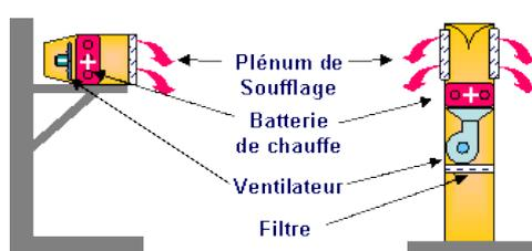
Supposez un aérotherme réglé en contrôle de la température d'un local.
