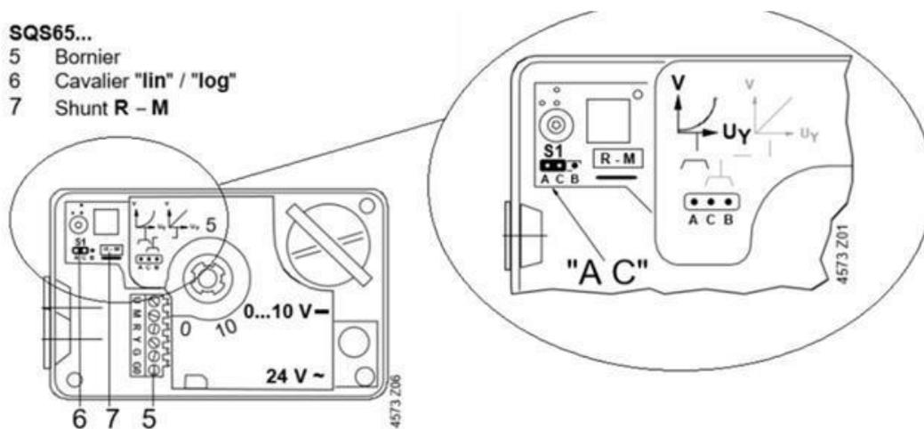
**QUESTION Q3:** En examinant attentivement le schéma ci-dessus, indiquer dans quelle position il faut disposer le cavalier (ou shunt) sur les picots A, C, B, à savoir AC ou CB, pour que la relation liant le signal du régulateur ( $U_Y$ ) à la position de la vanne ( $V$ ) :
