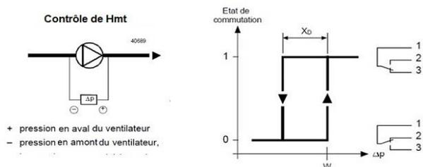
**Question Q3:** Justifiez le raccordement des flexibles du pressostat ci-dessous. Quel contact utiliserez-vous (1-2 ou 1-3) pour actionner l'alarme défaut?
