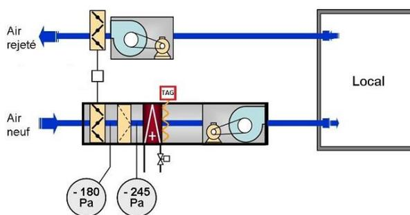
**Remarque :** en fait une bonne détermination du niveau maximal d'encrassement d'un filtre consiste à évaluer la variation de débit que son encrassement engendrera. Le sujet dépasse le cadre du présent dossier. Il faudra aussi tenir compte des préconisations des constructeurs, car les effets d'un filtre (son efficacité), peuvent varier selon son encrassement.
