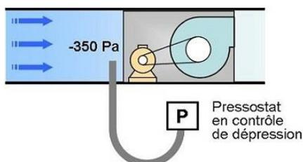
**Question Q2:** Quel serait le risque d'utiliser, pour contrôler le fonctionnement du ventilateur ci-avant dont la dépression normale à l'aspiration est de  $-350$  [Pa], le modèle de pressostat n° 3 (il serait alors réglé entre  $-300$  [Pa] et  $-350$  [Pa]).
