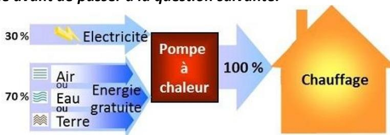
**QUESTION Q2:** Le coefficient de performance (COP) de la pompe à chaleur est le rapport entre la puissance calorifique qu'elle fournit et la puissance électrique qu'elle a absorbée pour permettre cette fourniture. Quel est le COP de la pompe à chaleur schématisée ci-dessus?
