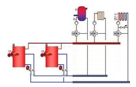
Le rendement des chaudières à condensation augmente à charge partielle. De ce fait si la chaufferie dispose de plusieurs chaudières à condensation, il est utile **de les mettre toutes en service même lorsque la demande est faible.**Ainsi, pour une température de retour de 35 [°C], Atlantic annonce ci-dessous sur une chaudière Modulo Control de 116 [kW]:
