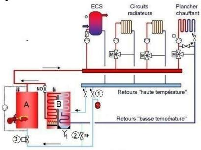
**Question** Q1: Quel est le rôle et le principe de réglage ou le principe de fonctionnement des robinets 1, 2, 3 ci-dessus?
