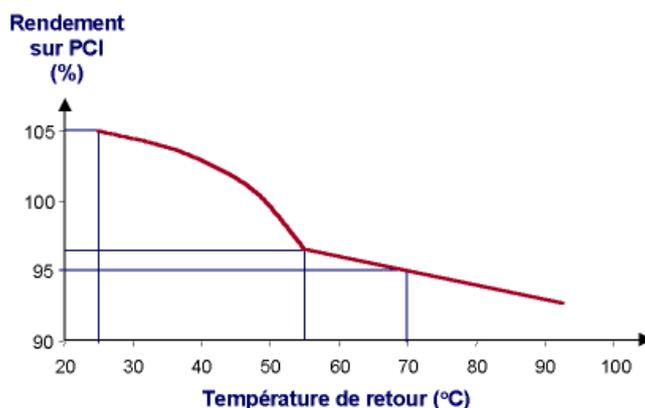
Question Q2: En utilisant le diagramme ci-dessus, et en tenant compte de la température de retour à la chaudière, déterminez le rendement de la chaudière à condensation définie ci-dessous.
