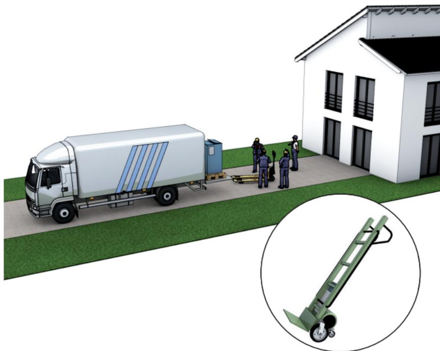
Le poids à vide des chauffe-eau thermodynamiques est généralement compris entre 70 et 150 kg, une attention particulière doit être portée pour minimiser le risque de basculement.
