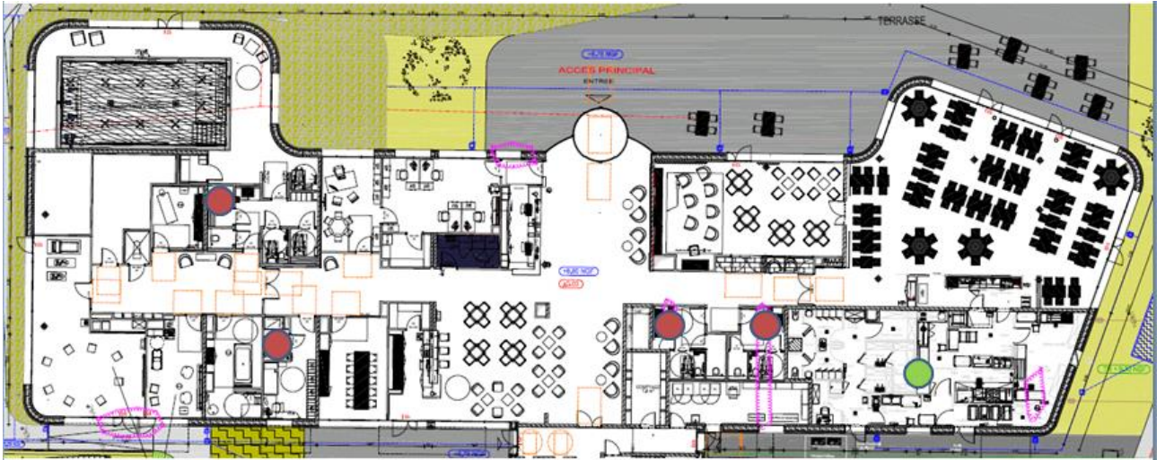
Emplacement des points de puisage : les points rouges représentent des sanitaires, le point vert la cuisine du restaurant.
