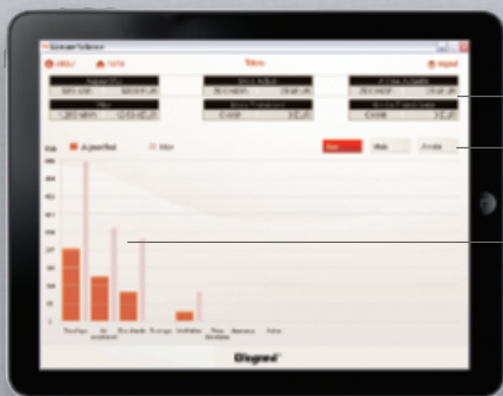
Exemple d’écran d’affichage de la consommation totale du chauffage d’un dispositif sur un mois
