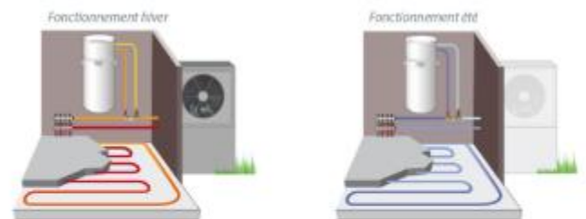
En hiver, le chauffe-eau thermodynamique Edel EAU prélève les calories gratuites de l'air extérieur, par l'intermédiaire du générateur qui alimente le plancher chauffant pour produire l'eau sanitaire à 60°C.
