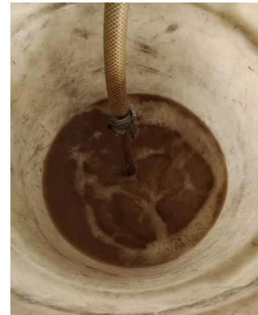
BOUES RECCUEILLIES LORS D'UN NETTOYAGE DE RÉSEAU (À GAUCHE). BOUES SUR BOUGIES MAGNÉTIQUES (À DROITE)
