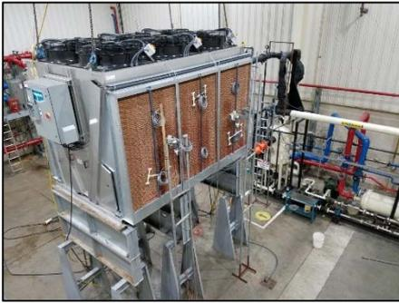
Evapco a procédé à des recherches et essais exhaustifs, en grandeur réelle (voir ci-contre), de la majorité des médias adiabatiques disponibles sur le marché et a démontré qu'aucun média n'est capable de réellement assurer 80% d'efficacité d'humidification à la vitesse d'air moyenne de 2,5 m/s. Les résultats de ces essais ont été publiés dans un livre blanc. Ce livre blanc a été présenté au colloque du CTI en février 2019 et rendu public.
