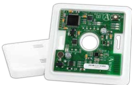
Platine électronique chargée de gérer le système au travers de dispositifs filaires et radio.
