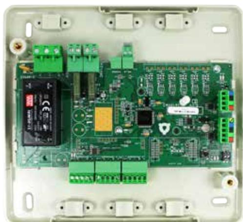
Platine électronique chargée de gérer le système au travers de dispositifs filaires et radio.
