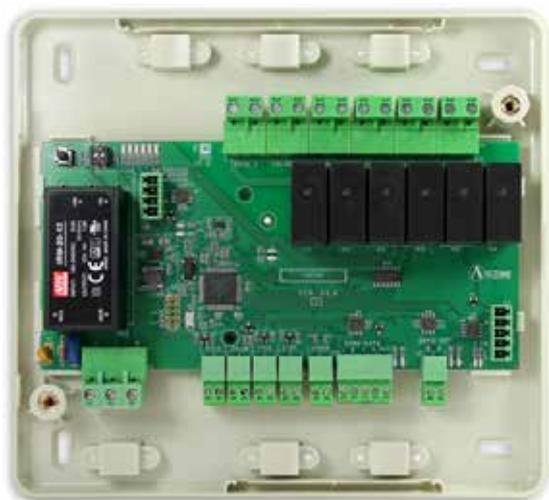
Le module de contrôle de production permet de gérer le réseau de distribution via des relais.
