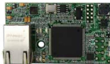
Cette passerelle permet d'intégrer les systèmes Airzone aux systèmes de gestion des bâtiments utilisant le protocole BACnet. Dispositif Plug&Play pour les systèmes Airzone qui permet de contrôler les paramètres du système de régulation. Compatible avec BACnet (ANSI/ASHRAE - 135) et BACnet / IP (ISO 16484 - 5).
