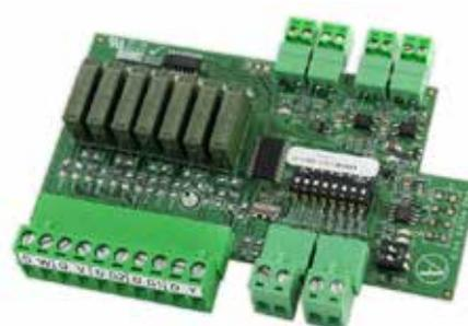
Passerelle de contrôle des unités de climatisation avec contrôle électromécanique.
