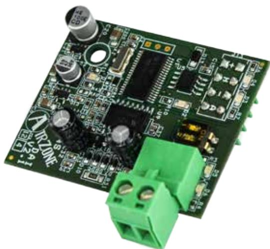
Cette passerelle permet d'optimiser le potentiel de la technologie **Inverter de l'unité monosplit ou DRV** tout en obtenant une climatisation intégrée.
