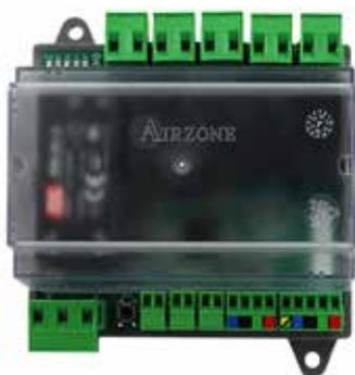
Ce module - passerelle permet de contrôler simplement un ventilo-convecteur monozone.
