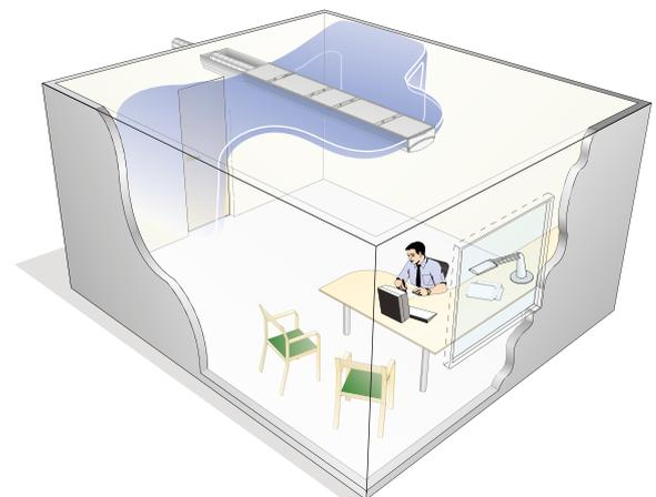
Figure 8. Exemple de diffusion déséquilibrée VariFlow.
