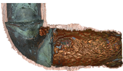
Exemple de corrosion-érosion d'un tube en cuivre
