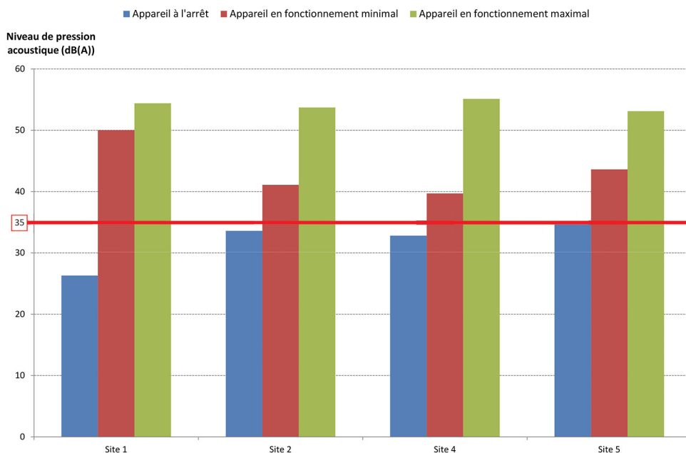
▲ Figure 11 : Niveaux de pression acoustique mesurés sur les différents sites avec l’appareil à l’arrêt et en fonctionnement à puissances réduite et maximale
