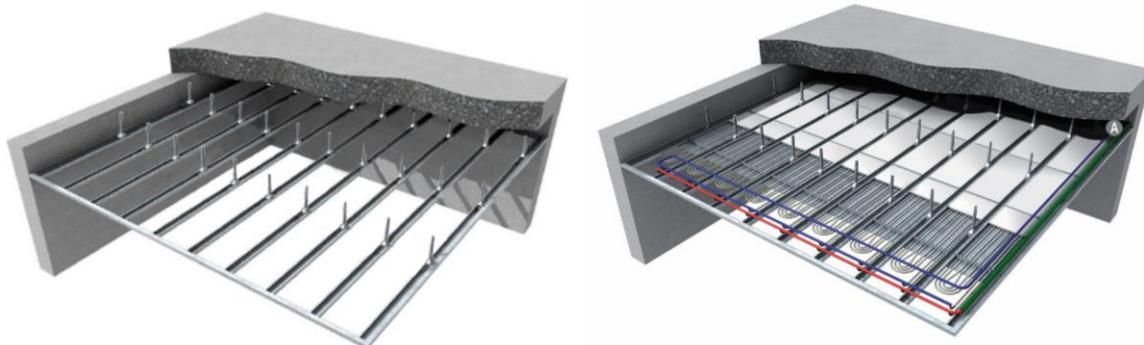
**Figure 5a – Pose des rails et de l'ossature secondaire** **Figure 5b – Installation des modules**
