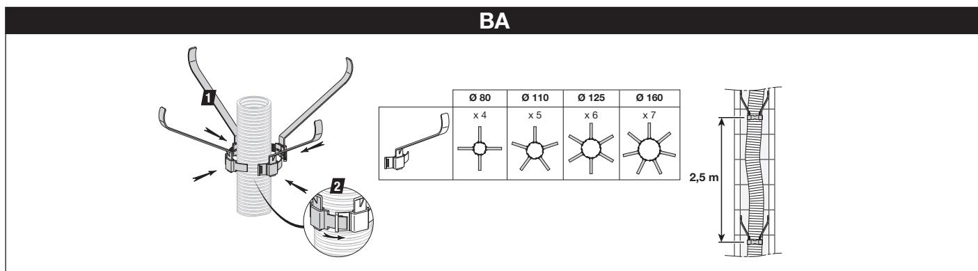
**F B CH** Montage des supports de conduit
