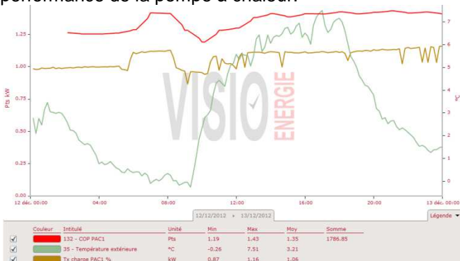
Figure 6: Evolution du COP en fonction du taux de charge
