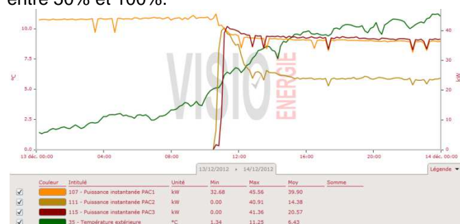
Figure 10: Modulation de la PAC 1 seule puis des trois PAC ensemble avec la PAC 3 à 60% de charge
