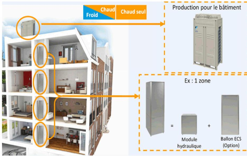
Unité extérieure en toiture / liaison de type VRV entre UE et les logements / Unité individuelle dans chaque logement pour le chauffage / ECS 200-260l/ climatisation
