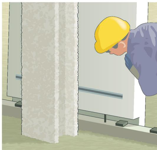
▲ Figure 61 : Pose sur cale avec système de brochage
