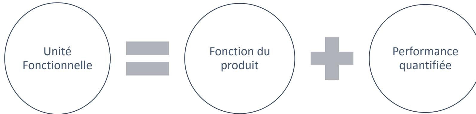
**Exemple d'une unité Fonctionnelle (UF) : Assurer une fonction d'isolant thermique sur 1m<sup>2</sup> de paroi avec une résistance thermique de 2,45 K.m<sup>2</sup>.W<sup>-1</sup>**
