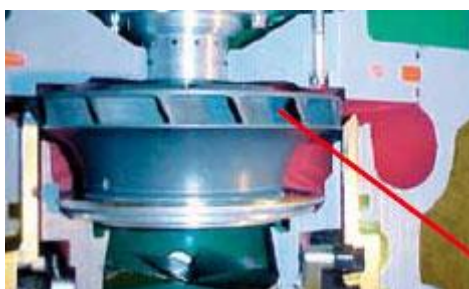
Diffuseur mobile obturant la zone de refoulement de la turbine
