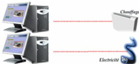
**La Gestion Technique Centralisée (GTC)** est un système de traitement des informations d'un seul domaine technique (chauffage, ou éclairages, ou climatisation, etc.) provenant d'un même site qui utilise généralement un réseau de communication propriétaire (propre au constructeur).
