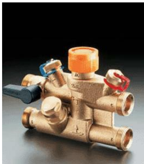
Robinet de réglage à quatre voies «Cocon 4» à technique de mesure «eco», avec prises de pression et robinets de vidange montés des deux côtés, filetage mâle 3/4" pour le raccordement universel de la tuyauterie.
