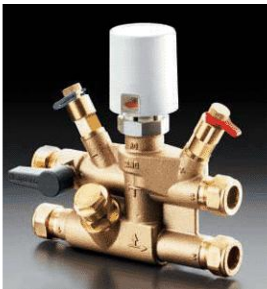
Robinet de réglage à quatre voies «Cocon 4» à technique de mesure «classic», filetage mâle 1/2" avec raccords à serrage 15 mm, prises de pression montées des deux côtés et moteur électrothermique.
