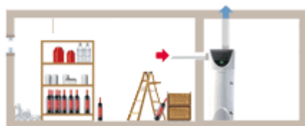
Installation sur air ambiant non chauffé
