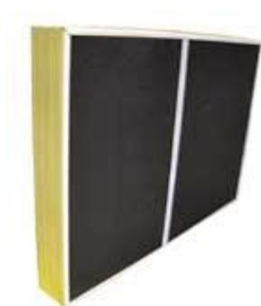
Le baffle acoustique SONIE BL Salle Blanche est pourvu d'un revêtement anti-défilage. Destiné à l'atténuation des nuisances sonores propagées dans les réseaux aérauliques, il est spécialement revêtu d'un tissu de verre. Son cadre aérodynamique en acier galvanisé intègre un bord arrondi, ce qui améliore jusqu'à 30% les pertes de charge habituellement observées sur des baffles standards.
