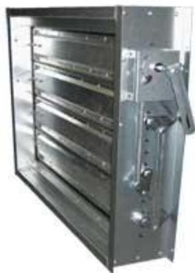
Le registre REDIN est un registre spécialement étudié pour salle blanche. Avec un cadre en acier galva ou en inox, des axes en acier zingué ou en inox et des joints en Ethylène-Propylène sur le cadre et les volets (ou en silicone avec une tenue à 200°C), il permet une étanchéité de classe 4C !
