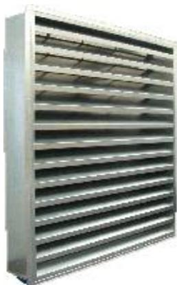
La grille acoustique GNB est utilisée pour l'atténuation des bruits de ventilation statique ou dynamique en façade de bâtiment. Sa conception vous apporte une double protection : pare pluie grâce au profil de lame spécialement étudié contre le bruit grâce au matériau isolant placé à l'intérieur des lames.
