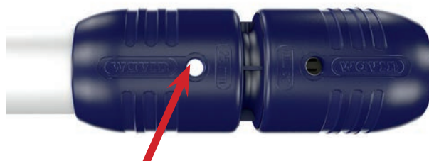
Figure 5 : Un regard dans le capuchon permet de contrôler que le tube est inséré jusqu'en butée.
