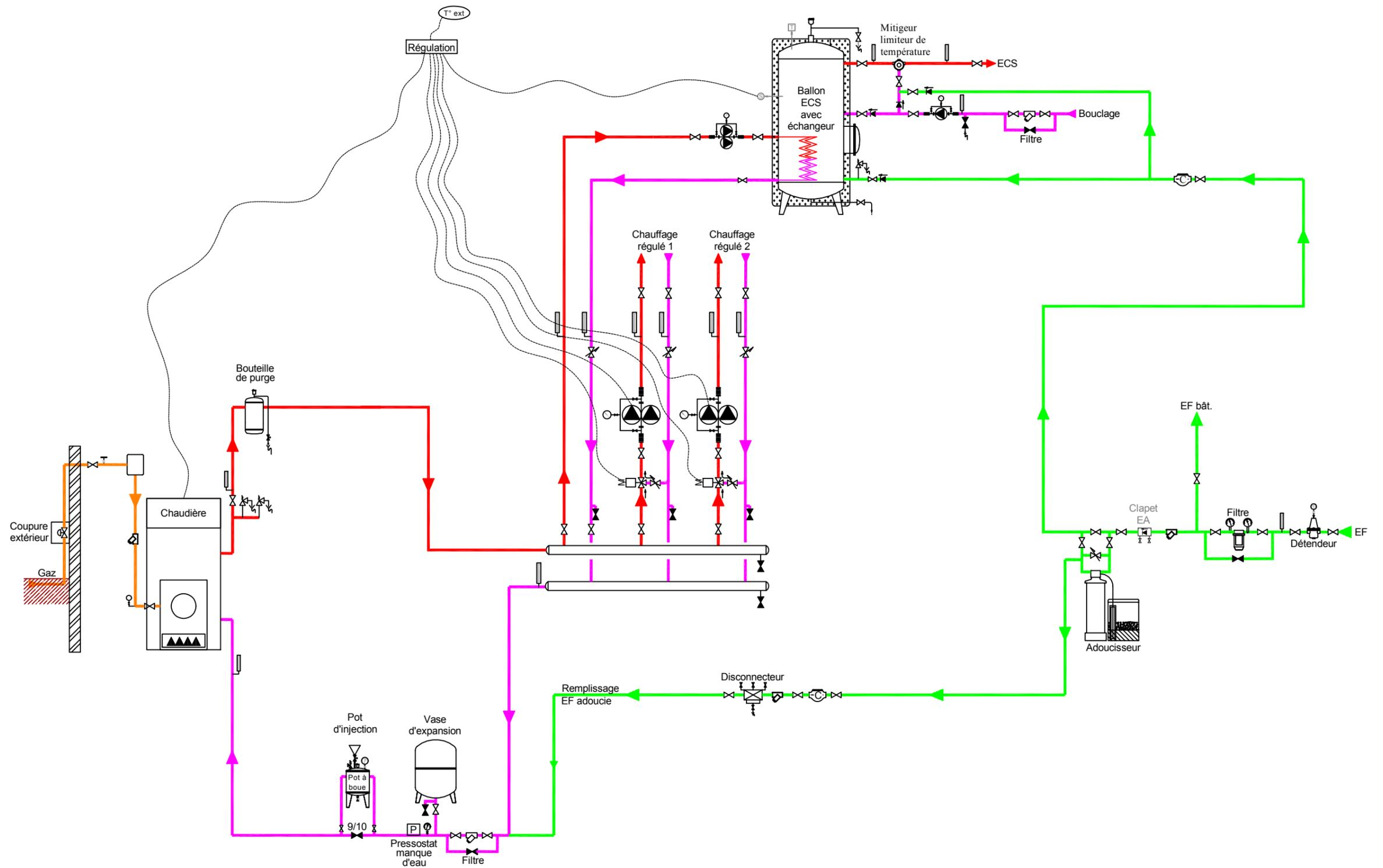
**Schéma hydraulique de production de chauffage et d'ECS**
