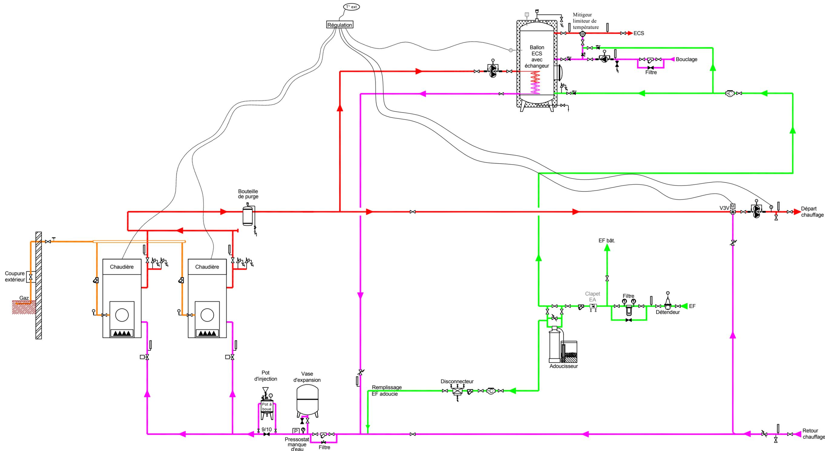
**Schéma hydraulique de production de chauffage et d'ECS**
