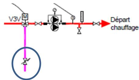
La **vanne de réglage** sur le retour de la vanne trois voies est parfois nécessaire quand l'autorité de la vanne trois voies est insuffisante par rapport à la perte de charge de la chaudière.
