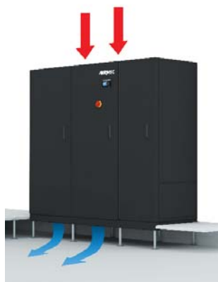
Exécution standard avec aspiration à partir du haut et refoulement en bas, avec sous-base pour sol surélevé.
