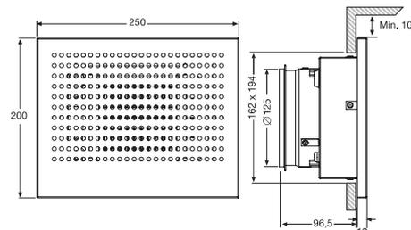
**Bouche de soufflage chauffante plafonnrière apparente, avec résistance PTC intégrée pour maisons passives.**
