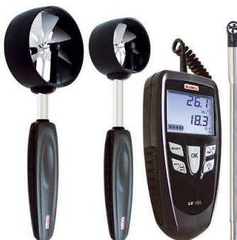
Figure 7 - Anémomètres à hélice de différentes tailles (doc. KIMO)
