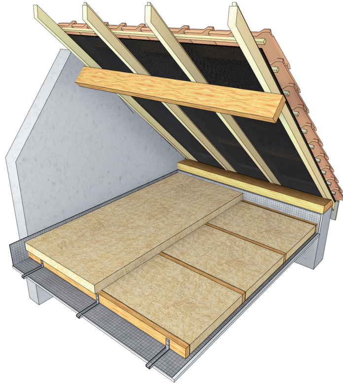
▲ Figure 6 : Isolation en combles perdus sur plafond : cas des charpentes traditionnelles
