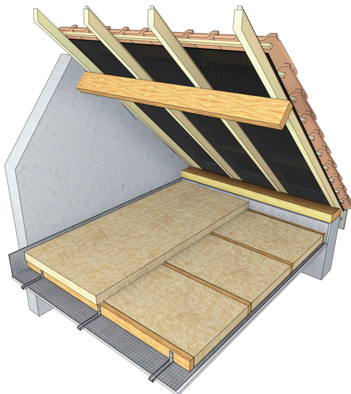
▲ Figure 58 : Isolation en combles perdus sur plafond : cas des charpentes traditionnelles
