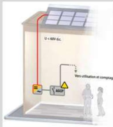
La tension du générateur PV étant choisie inférieure ou égale à 60V d.c. , cette disposition assure la sécurité totale des interventions à l'intérieur comme à l'extérieur des locaux accessibles au public.
