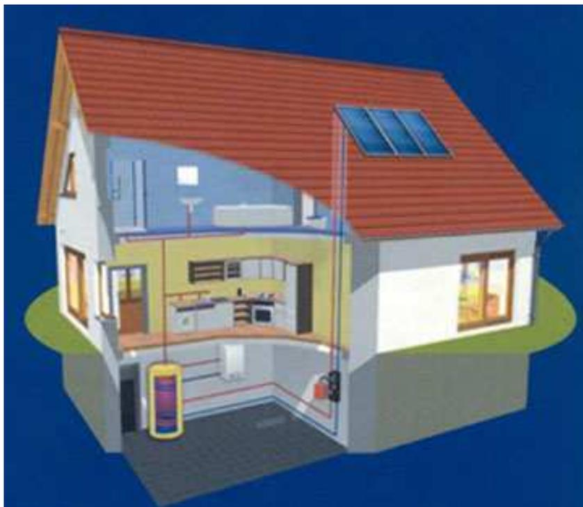
Ballon d'accumulation à l'intérieur de l'édifice. Circulation du fluide caloporteur par un système de pompe.
