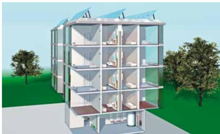
Individualiser le confort et les charges tout en faisant appel à la multi-énergie dans l'habitat collectif : les solutions existent, comme l'association de chaudières gaz à condensation et de capteurs solaires.
