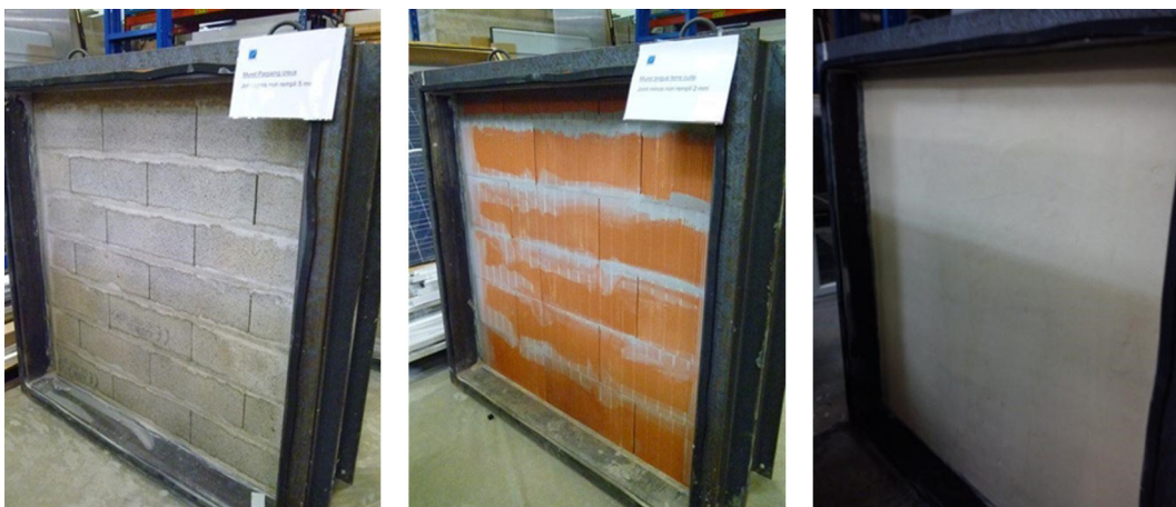
▲ Photographies 1, 2 et 3 : Exemple de montage de maçonnerie : avant enduit en blocs de béton (à gauche), avant enduit en briques de terre cuite (au centre) et après enduit (à droite).
